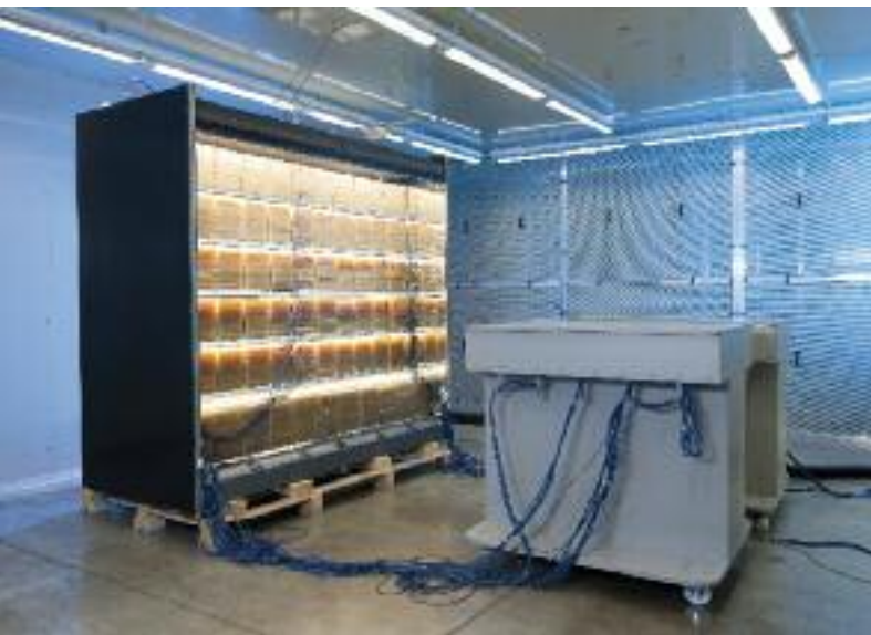
Prüfungssituation mit Testpaketen bei Pluskühlung
