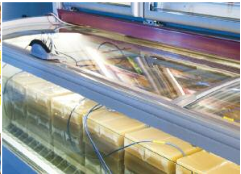
Minuskühlung: Prüfsituation mit Testpaketen in TK-Möbel mit Glasabdeckung
