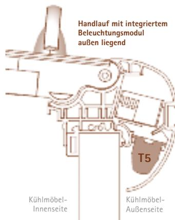
Leuchtstoffröhren funktionieren besser in einer warmen Umgebung außerhalb des CombiSETS. Die schädliche Infrarotstrahlung wird durch die seitliche Isolierverglasung größtenteils reflektiert.
