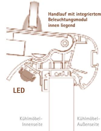
Die innen liegende LED Beleuchtung kann noch durch zusätzliche LED, integriert in die Push-Gleitschiene, ergänzt werden. Geringer Stromverbrauch und lange Lebensdauer zeichnen die Verwendung von LED aus.
